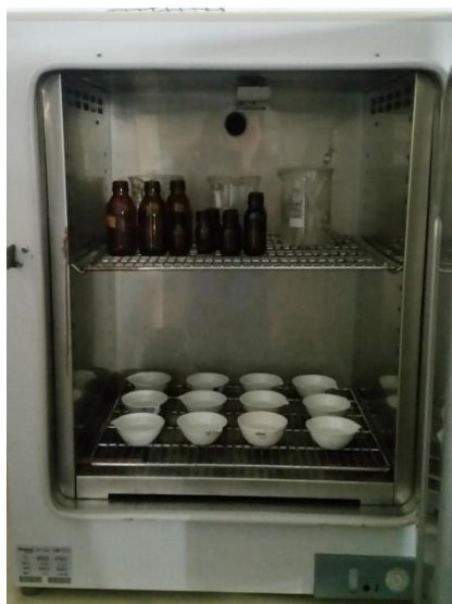
Figura IV. Estufa con cápsulas durante la determinación de residuo seco
