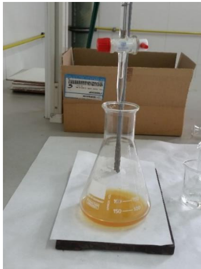
Figura VI. Muestra con indicador después del punto de equivalencia en la determinación de cloruro
