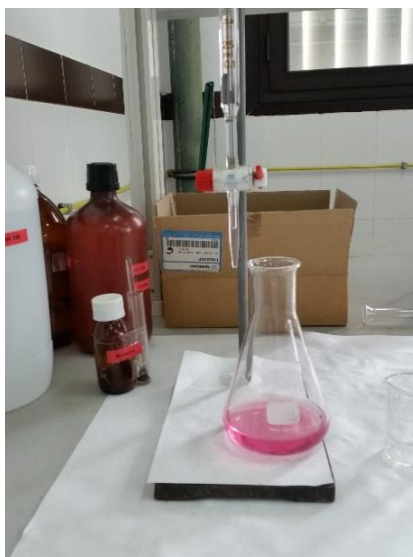
Figura IX. Muestra con indicador antes del punto de equivalencia en la determinación de calcio
